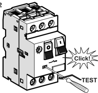
MPCB ini mengamankan motor dari korsleting dan kelebihan beban (overload) pada rangkaian AC 50/60 Hz.
